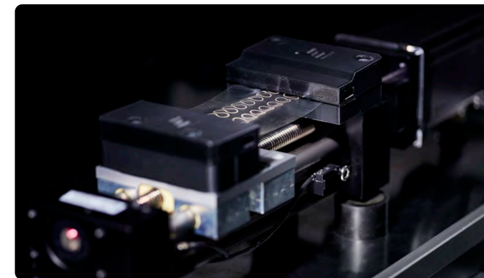
Zugversuch bei elastischen Leiterbahnen
